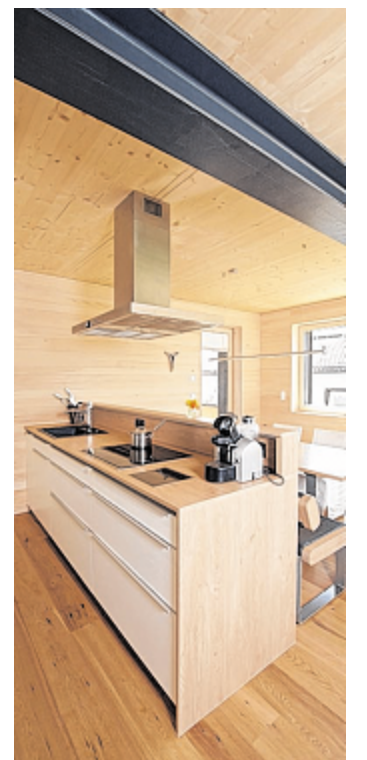
Trotz der dichten Verbauung rundum sind die Räumlichkeiten hell und freundlich. Mit kleinen Entwurfstricks wie dem Einsatz eines Stahlträgers und der Absenkung der Wohnebene konnte eine möglichst große Raumhöhe erreicht werden. Fotos: ELL, Zweiraum
